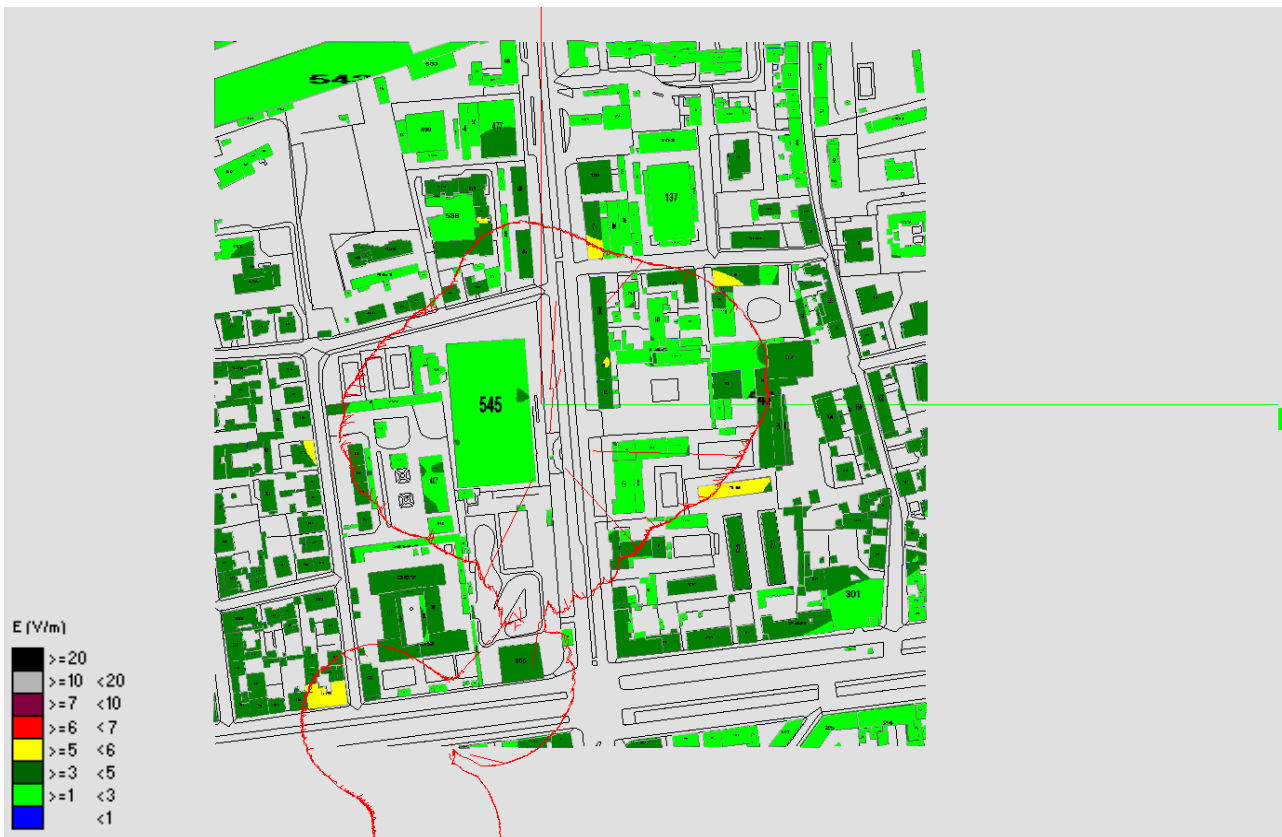
Fig. 38 Impatto elettromagnetico – Zona Area Campo Sportivo Vle I Nievo - Palo Sud – Vista dall'alto
