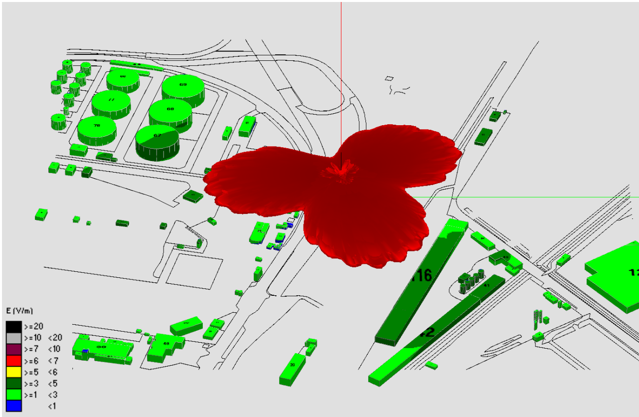
Fig. 2 Impatto elettromagnetico – Zona Via Leonardo da Vinci c/o Terminal ferroviario – 0°/Nord
